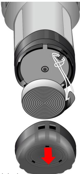
4. Suelte y retire la correa de transporte (si está instalada).
