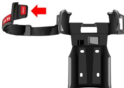
3. Deslice la EPIRB en el soporte con el acollador situado hacia atrás hasta que quede fijado.
