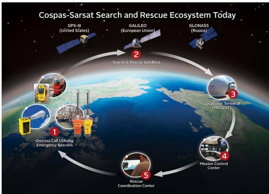
1. El proceso comienza con la activación de una baliza de socorro (EPIRB para uso marítimo, PLB para uso personal y ELT para uso en aviación) en una situación de emergencia y el envío de una señal a 406 MHz.
